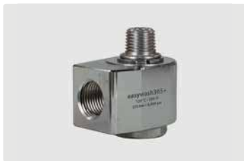
3/8" IG : 1/4" AG. DN 7. Макс. 275 bar / 30 об/мин / 120 °C
