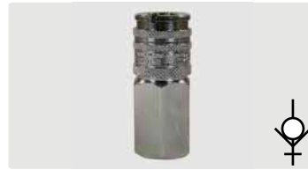
Муфта : IG. Хромир. латунь / хромир. сталь. С вентилем. Макс. 200 bar / 100 °C
