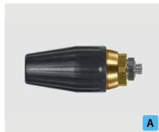
1/8" AG. Угол распыления 20°. 100 - 250 bar. Макс. 100 °C
