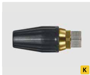
M18 IG. Угол распыления 20°. 100 - 250 bar. Макс. 100 °C
