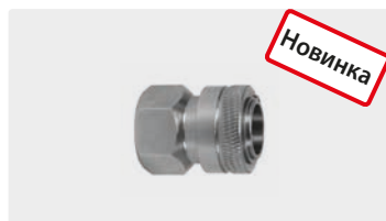
Муфта : IG. Нерж. сталь. Макс. 150 bar / 90 °C
