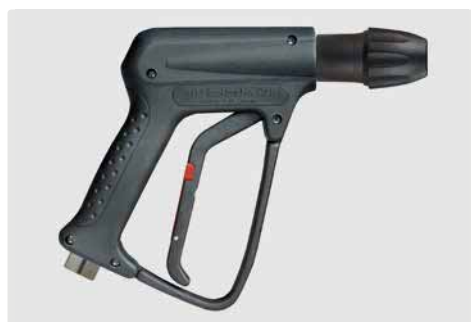
Проф. пистолет R+M EcoLine No. ONE с муфтой KW. Макс. 250 bar / 45 л/мин / 150 °C
