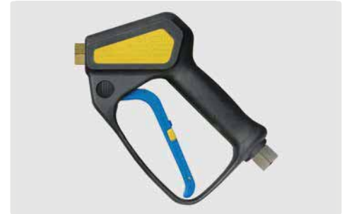
Профес. пистолет. Weep-исполнение. Макс. 310 bar / 45 л/мин / 150 °C
