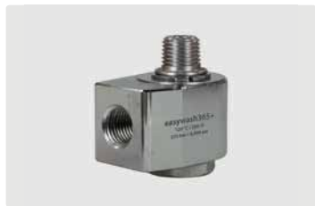
1/4" IG : 1/4" AG. DN 7. Макс. 275 bar / 30 об/мин / 120 °C
