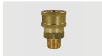
Муфта : AG. Латунь. Макс. 150 bar / 100 °C
