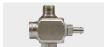
Наконечник 9 мм : 1/2" AG вращ. : 1/2" IG. Нерж. сталь. Для подведения сжатого воздуха. Макс. 350 bar / 60 °C
