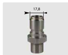
Штекер : AG. Нерж. сталь. 60° упл. конус. Макс. 250 bar / 150 °C
