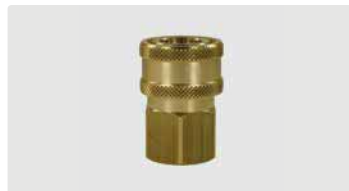
Муфта : IG. Латунь. Макс. 150 bar / 100 °C
