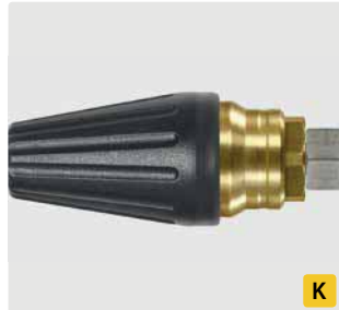
M18 IG. Угол распыления 20°. 200 - 400 bar. Макс. 100 °C
