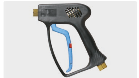
Профес. пистолет. Исполнение с защитой от замерзания. Макс. 275 bar / 45 л/мин / 150 °C
