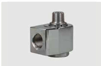
3/8" IG : 1/4" AG. DN 7. Макс. 150 bar / 30 об/мин / 90 °C
