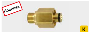
3/8" AG : TR22 IG. K-Lock 5. Латунь. Макс. 400 bar / 150° C
