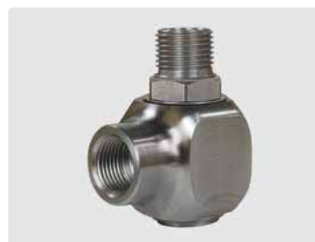
1/2" IG : 1/2" AG. DN 12. Макс. 300 bar / 30 об/мин / 90 °C
