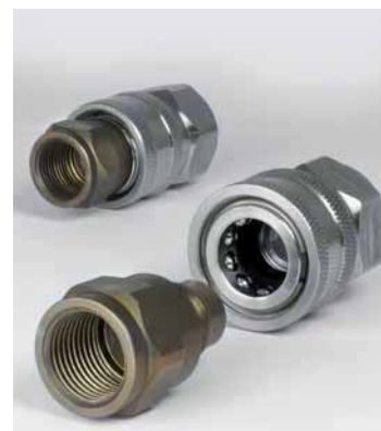
Штекер : IG. Закаленная нержавеющая сталь. Макс. 550 bar / 100 °C
