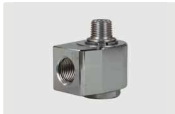
3/8" IG : 1/4" AG. DN 7. Макс. 150 bar / 30 об/мин / 90 °C
