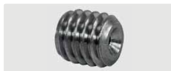
Полная струя 500 bar. Закаленная нерж. сталь Внутренний шестигранник 2,5мм
