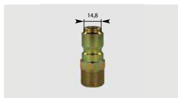
Штекер : AG. \varnothing 14,8 мм. Оцинк. сталь. Макс. 150 bar / 100 °C
