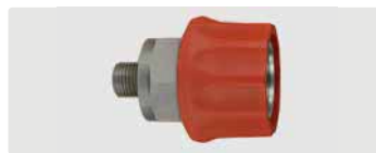
Муфта : AG. Нерж. сталь. Макс. 600 bar / 150 °C
