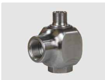
1/2" IG : 3/8" AG. DN 10. Макс. 300 bar / 30 об/мин / 90 °C
