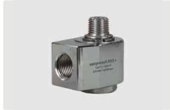
3/8" IG : 1/4" AG. DN 7. Макс. 275 bar / 30 об/мин / 120 °C
