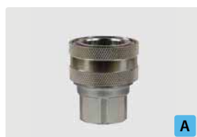
Муфта : IG. Никелир. латунь. Макс. 250 bar / 150 °C
