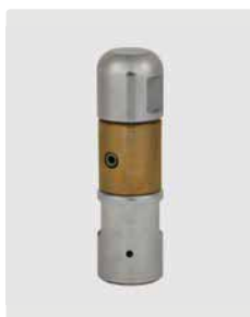
1/8" IG. Боков. струя 2. Нерж. сталь. Ротационная часть из бронзы ВД. Компактное исполнение, универсальное применение. Экстремально высокая чистящая способность, удаляет самые жесткие загрязнения. \uparrow 63 мм. \varnothing 12 мм. Вес 0,18 кг. Макс. 1.000 bar
