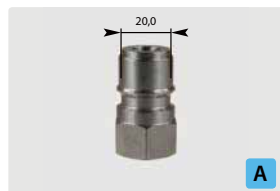
Штекер : IG. Нерж. сталь. Макс. 250 bar / 150 °C
