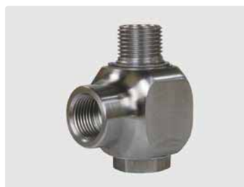
1/2" IG : 1/2" AG. DN 12. Макс. 300 bar / 30 об/мин / 90 °C
