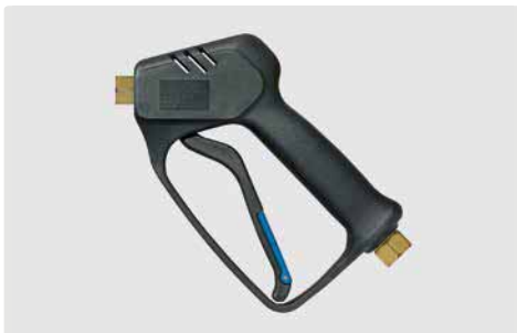
Профес. пистолет. Weep-исполнение. Макс. 210 bar / 25 л/мин / 150 °C
