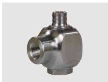
3/8" IG : 3/8" AG. DN 10. Макс. 400 bar / 30 об/мин / 90 °C
