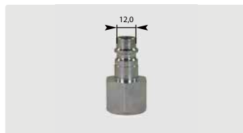
Штекер : IG. \varnothing 12 мм. Никелир. сталь. Макс. 200 bar / 100 °C
