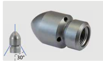
3/8" IG. Наружный \varnothing 30 мм. 4 отверстия сзади, с фронт. отверстием
