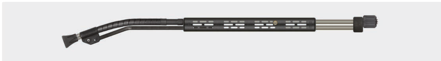
HV M22 вращ. Копье ST-85 Push & Pull с защитой форсунки ST-10 без форсунки ВД. Макс. 210 bar / 150 °C
