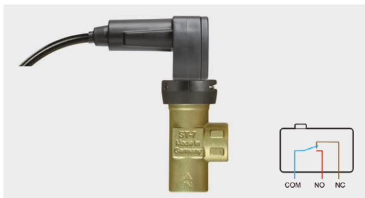
3/8" IG. Класс защиты IP65. Кабель 1.200 мм. 10 А. 250 V. Ток включения 20А (открывание) и 15А (закрывание). Макс. 350 bar / 45 л/мин / 80 °C
