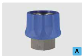
Муфта : IG. Нерж. сталь. Макс. 250 bar / 150 °C
