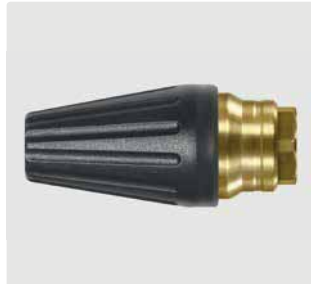
1/4" IG. Угол распыления 20°. 200 - 400 bar. Макс. 100 °C
