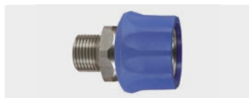
Муфта : AG. Нерж. сталь. 60° упл. конус. Макс. 250 bar / 150 °C
