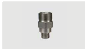
M22 AG : 1/4" AG. Длинное отверстие. Макс. 400 bar / 150 °C
