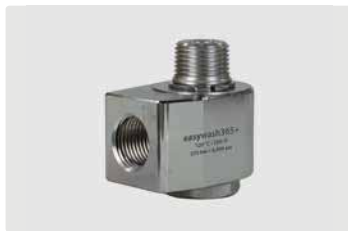
3/8" IG : 3/8" AG. DN 7. Макс. 275 bar / 30 об/мин / 120 °C
