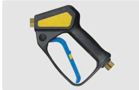
Профес. пистолет. Weep-исполнение. Макс. 310 bar / 45 л/мин / 150 °C
