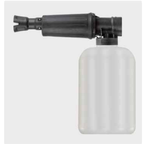
1/4" IG. Пеноинжектор с дозировкой и бутылкой. Макс. 300 bar / 80 °C
