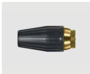
1/4" IG. Угол распыления 20°. 100 - 250 bar. Макс. 100 °C
