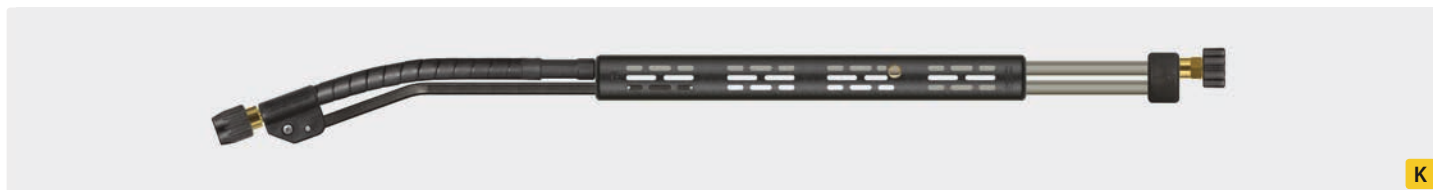
HV M22. Копье ST-85 Push & Pull с защитой форсунки ST-10 без форсунки ВД. Макс. 210 bar / 150 °C
