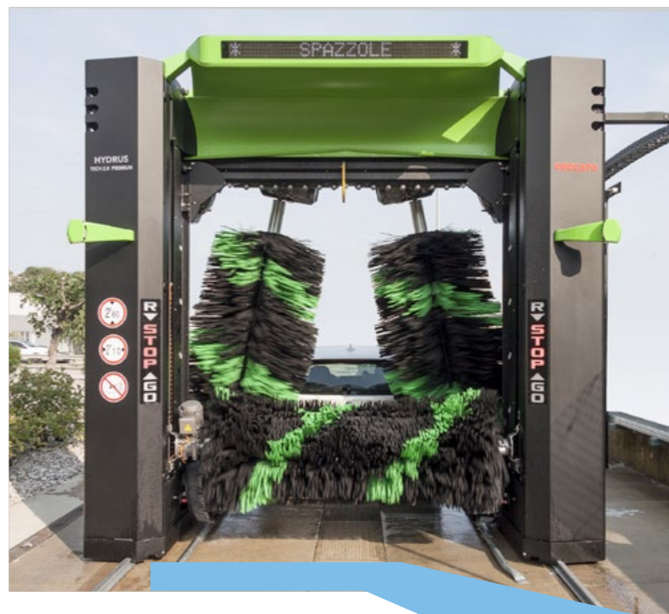
Прерывистый контур с использованием покачивания щеток
