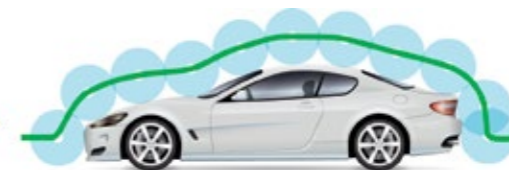
Не прерывный контур с использованием постоянного прижима щеток
